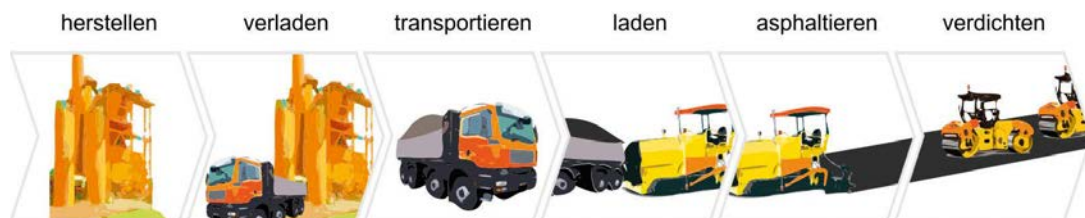
Abb. 1: Prozesskette beim Asphaltstraßenbau [1]
