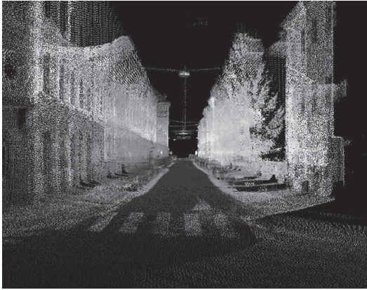
Abb. 17: LiDAR Punktwolke aus einem fahrenden Auto in Graz. Die Punktdichte beträgt in diesem Fall auf den Hausfassaden etwa 60 Punkte pro m^2 (Streetmapper im Auftrag von Microsoft).
