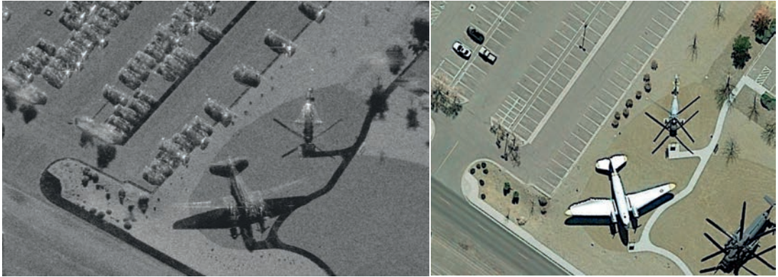
Abb. 19: Synthetisches Apertur-Radar SAR kann heute geometrische Auflösungen im Bereich von 10 cm erreichen und zu interferometrisch erfassten Höhenmodellen gleicher Dichte führen. Das Beispiel zeigt ein Bild aus dem System von Sandia Laboratories mit 10 cm Pixeln und ein Luftbild derselben Szene (Quelle: Richard Carande, NevaRidge Inc., Boulder, Colorado).
