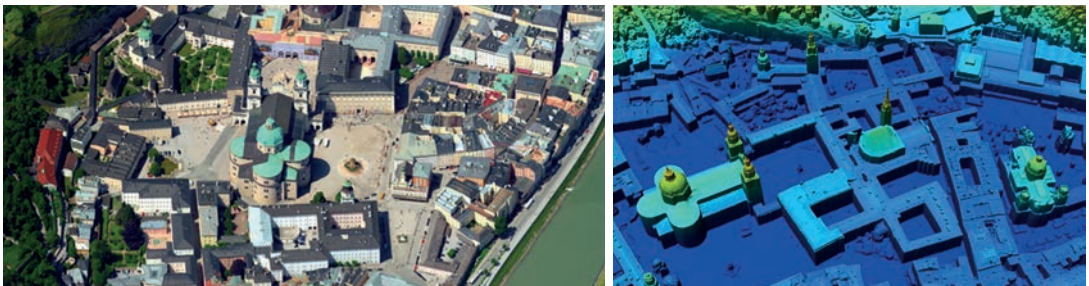
Abb. 10: Aus vertikalen und schräg aufgenommenen Luftbildern, wie hier im Falle von Salzburg mit einem Ultra-Cam-Osprey-Schrägbild (li), werden sehr dichte Punktwolken erzeugt, die pro Quadratmeter bis zu 1000 Punkte beinhalten können, eben zu jedem Bildpunkt ein Koordinatentripel im Gelände (re).
