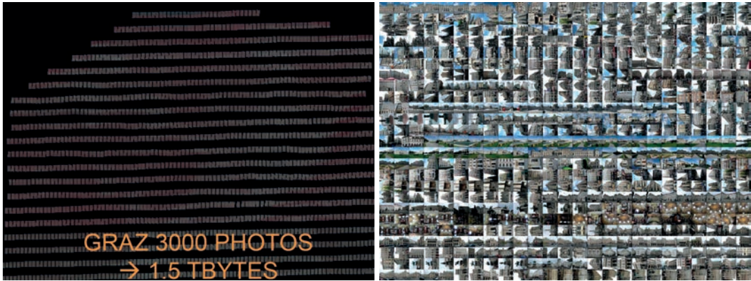
Abb. 25: Sehr große Bildverbände mit tausenden Luftbildern erfordern die Verfügbarkeit von Benutzerschnittstellen am Computer, die es ermöglichen, alle Bilder eines Verbandes übersichtsmäßig anzuzeigen und in Echtzeit in jedes beliebige Detail zu zoomen. Die Beispiele zeigen einen 3.000-Photoblock aus Graz und einen Wiener Block mit 2.700 Luftbildern.
