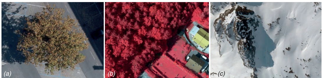
Abb. 11: Beispiel eines (a) Rot-Grün-Blau Farbbildes mit 3 cm Pixeln einer UltraCamXpin in Leibnitz; (b) eines Falschfarbenbildes aus 10 cm Pixeln in Infrarot-Rot-Grün aus Gleisdorf und (c) eines Schneebildes mit schwieriger Radiometrie in Schladming mit 15 cm Pixeln. Die Radiometrie umfasst etwa 7.000 Grauwerte, die den oft nur etwa 100 Grauwerten in typischen Luftfilmbildern gegenüberstehen.
