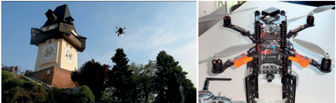
Abb. 7: Ein Micro-Aerial Vehicle (MAV) im Flug und in der Werkstatt [Wendel, Irschara, Bischof, 2011]. MAV ist die in der Robotik übliche Bezeichnung. In der Vermessung spricht man eher von Unmanned Aerial Systems (UAS). Die Kamera ist mit ihren Systemkomponenten im MAV-UAS Fluggerät integriert.
