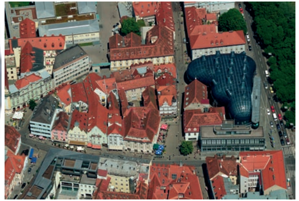
Abb. 16: Schräg abbildende UltraCam Osprey und Beispiel eines Schrägbildes vom Kunsthaus in Graz. Die Bodenauflösung im Schrägbild variiert zwischen 7cm und 15 cm.
