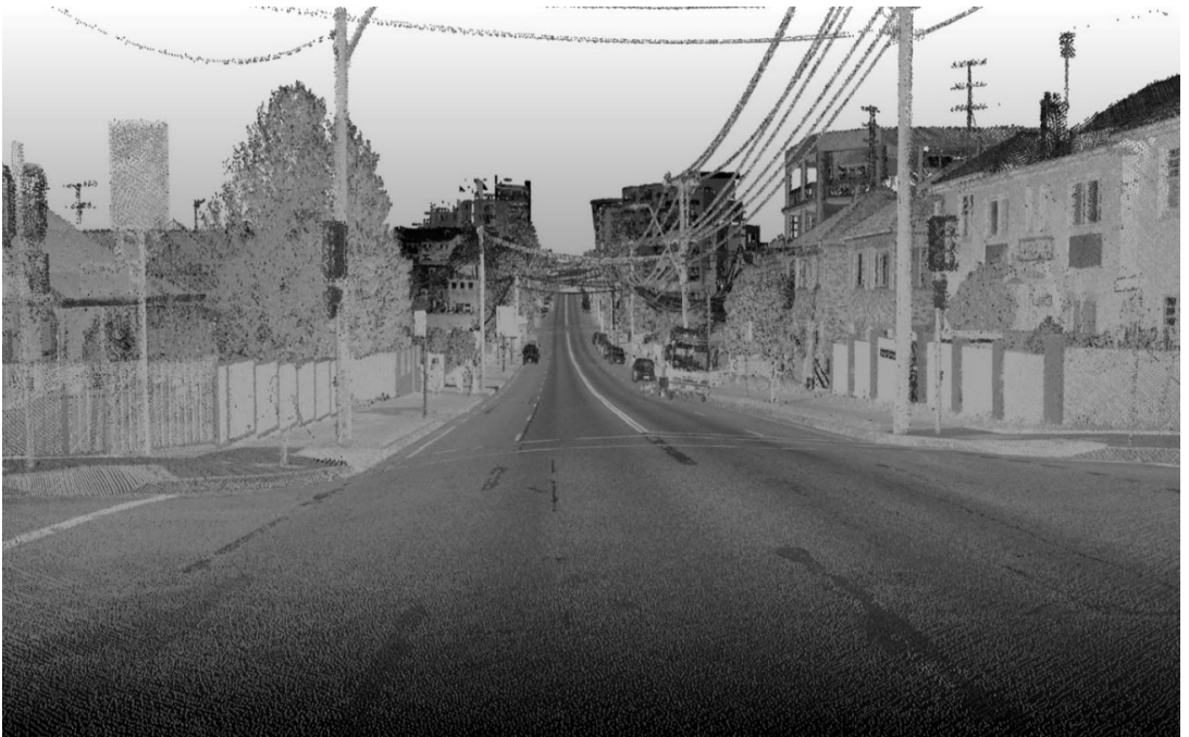
Abb 4: Typische Punktwolke des Mobile Mapping „auf der Straße“
