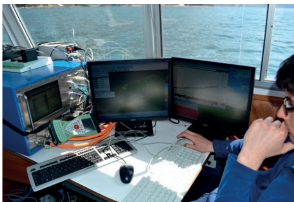
Abb. 1: Echolot-Messboot mit RTK-GNSS und IMU Sensorik und Operator-Arbeitsplatz
