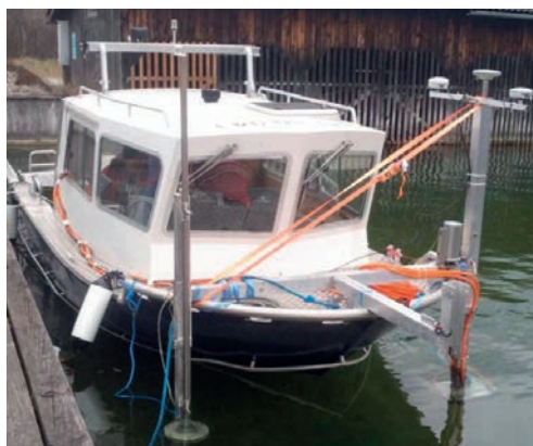
Abb. 1: Echolot-Messboot mit RTK-GNSS und IMU Sensorik und Operator-Arbeitsplatz
