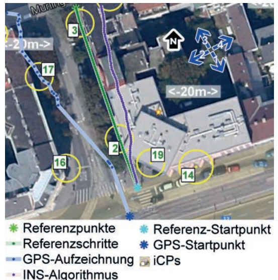
Abb. 3: Trägheitsnavigation mit INS-Algorithmus im Outdoor-Testgebiet
