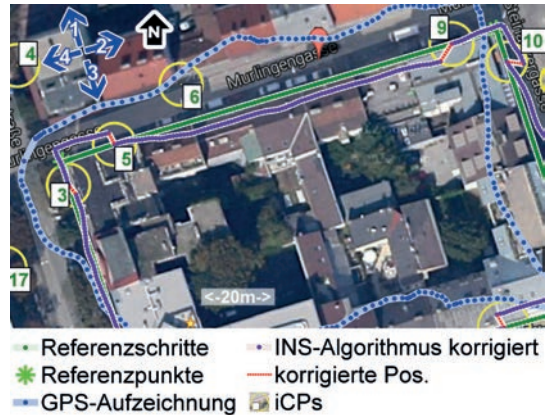
Abb. 6: Beispiel für die Korrektur der Positionen durch Erkennen der iCPs
