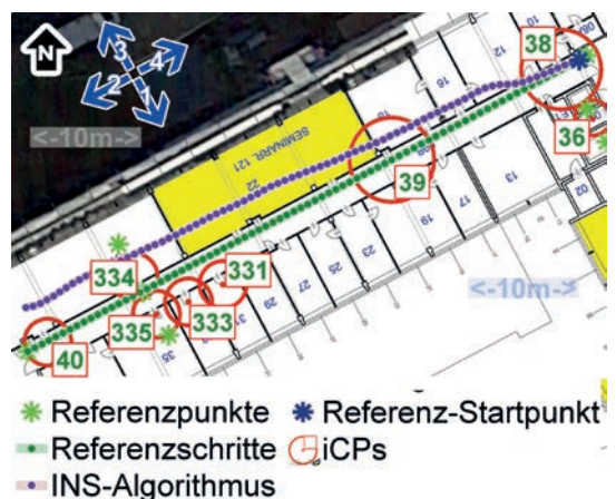
Abb. 4: Trägheitsnavigation mit INS-Algorithmus im Indoor-Testgebiet
