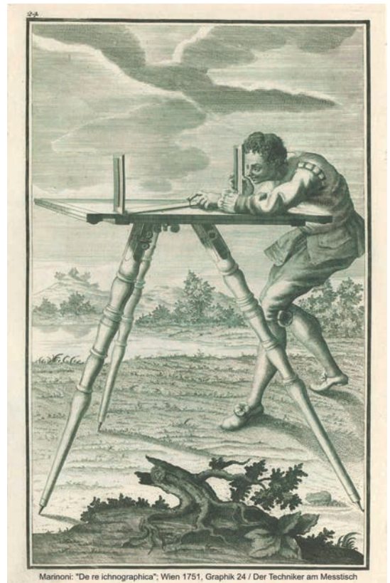
Abb. 12: Der Messtisch zusammen mit dem Diopterlineal als Visiereinrichtung; dies ist eine der bekanntesten Darstellungen des Messtisches, entnommen dem Buch von J. J. Marinoni „De re Ichnographica“, Wien, 1751 47) (ETH-Bibliothek Zürich Signatur: Rar 771 q)
