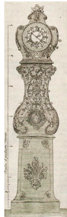
Abb. 87.1: Pariser Äquationsuhr von Le Faucheur Alexandre, bei der die Stellung einer zusätzlichen Skala durch eine Kurvenscheibe gesteuert wurde, um so auch die wahre Sonnenzeit anzuzeigen („mechanische Sonnenuhr“); auf dem Zifferblatt oberhalb von XII ist angegeben: „Temporis Aequalitas“; angezeigte Uhrzeit (mittlere Sonnenzeit): 2 Uhr 53' 29". Abb. 87.2: die kunstvoll gestaltete Äquationsuhr in ganzer Größe; beide Abb. aus: „De astronomica specula domestica“, Lib.II, S. 186 und S. 191 [beider Quelle: ETH-Bibliothek Zürich, Sign.: Rar 8917 q]
