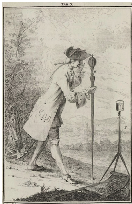
Abb. 41.1 und 41.2: Anwendung des Squadro (li), aus: Marinoni „De re ichnometrica“, 1775, Graphiken S. 25 (Tafel X) und S. 29, (Tafel XI) [Quelle: ETH-Bibliothek Zürich, Sign.: RAR 1072 q]
