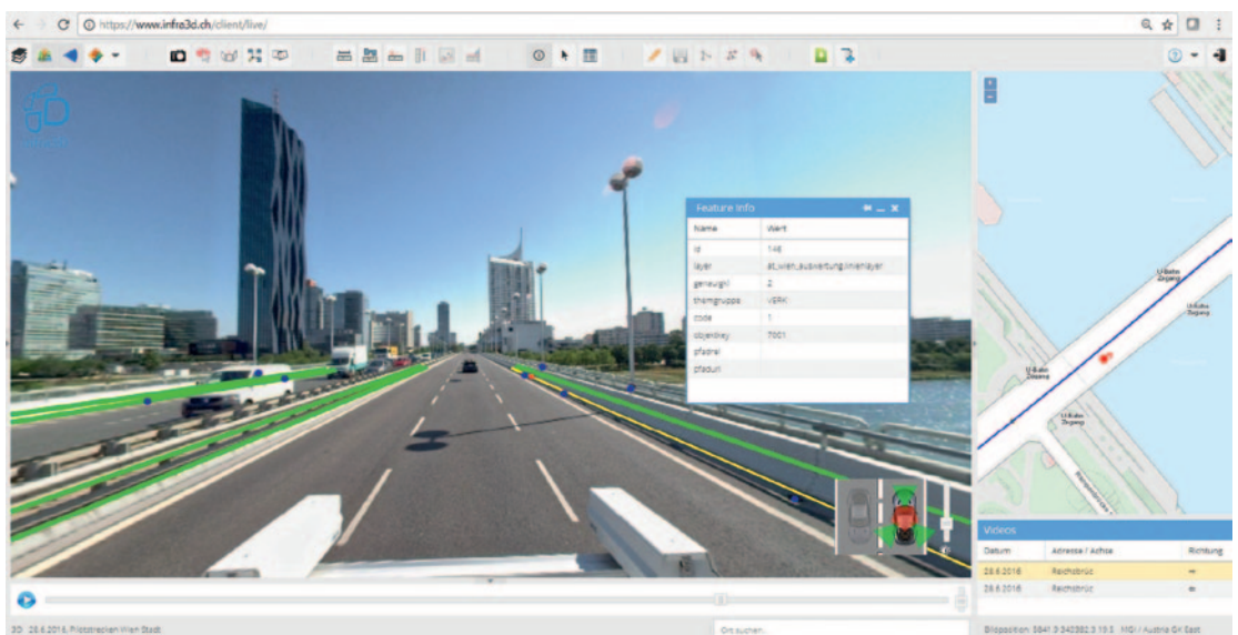
Abb. 5: infra3DCity Service der Stadt Wien (Österreich) im Rahmen des Projektes Wien gibt Raum; dargestellt sind direkt aus den Bilddaten digitalisierte Straßenmöblierungsobjekte für den Aufbau eines Stadtweiten Katasters
