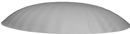
Abb. 6: CAD Darstellung der Approximierten B-Spline Fläche
