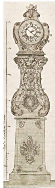
Abb. 52.1: Pariser Äquationsuhr von Le Faucheur Alexandre, bei der die Stellung einer zusätzlichen Skala durch eine Kurvenscheibe gesteuert wurde, um so auch die wahre Sonnenzeit anzuzeigen („mechanische Sonnenuhr“); auf dem Zifferblatt oberhalb von XII ist angegeben: „ Temporis Aequalitas “; angezeigte Uhrzeit (mittlere Sonnenzeit): 2 Uhr 53' 29".
