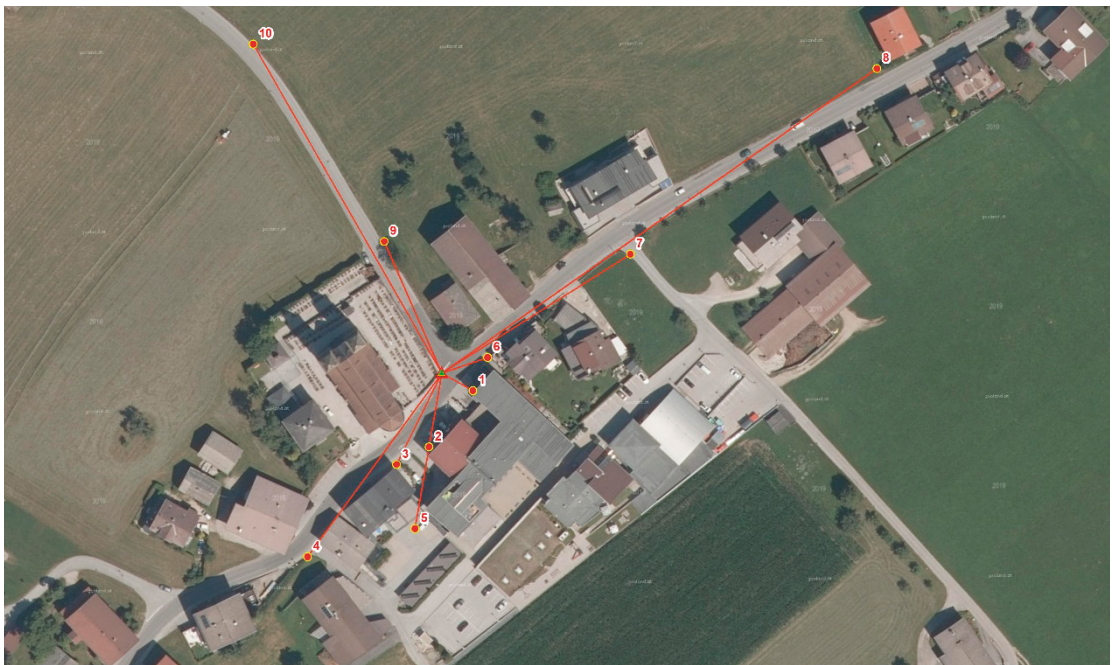
Abb. 1: Messanordnung freie Stationierung
