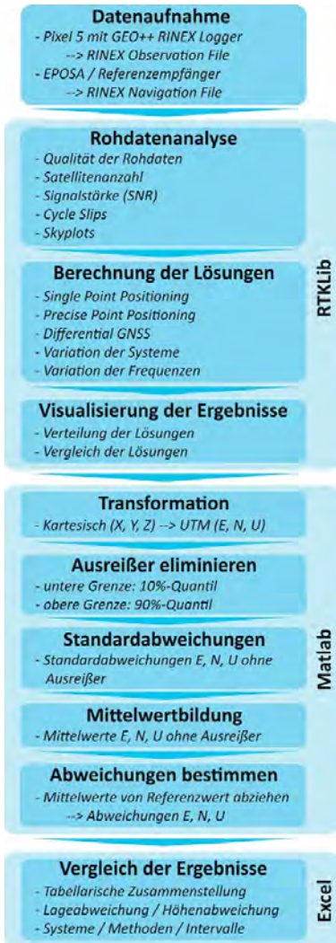
Abb. 1: Arbeitsablauf in Form eines Flussdiagramms
