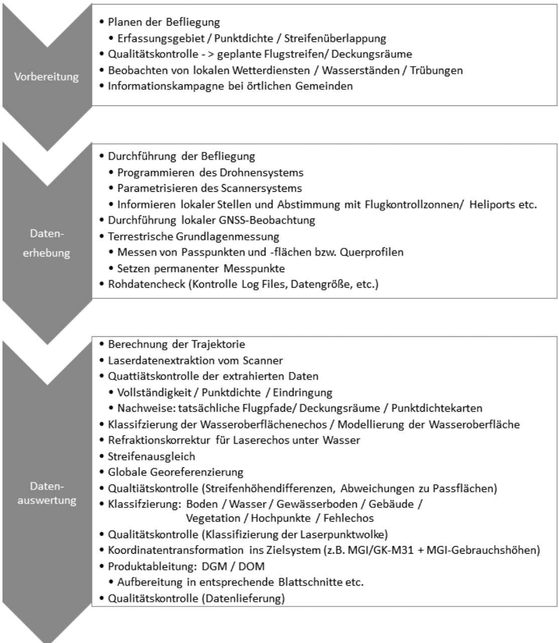
Abb. 3: Workflow einer topo-bathymetrischen UAV- Laserscanning Messkampagne
