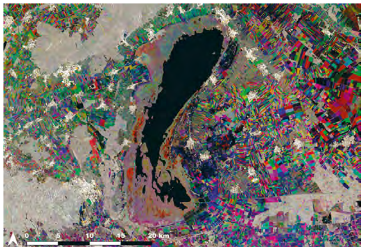
Abb. 6: Sentinel-1 Falschfarbenbild basierend auf Mittelwerten der VH Rückstreumessungen für die Monate Juli 2022 (Rot), Juli 2019 (grün) und Juli 2015 (Blau)
