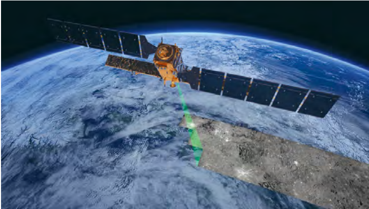
Abb. 1: Aufnahme der Erdoberfläche durch den Radarsatelliten Sentinel-1 (Copyright ESA). Die im Bild gezeigten Radardaten wurden an der TU Wien berechnet [15].
