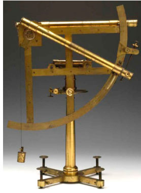
Abb. 37: Bird, tragbarer astronomischer Quadrant, 1760
